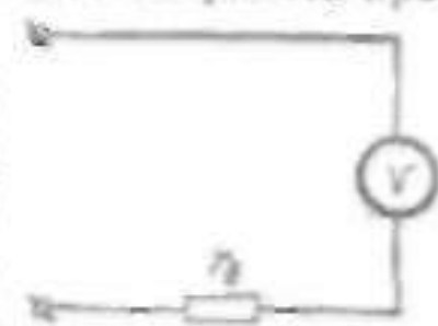
Рис. 85. Схема соединения вольтметра с добавочным сопротивлением
