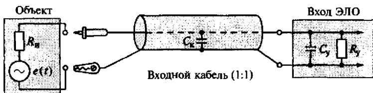
Рис. 4.21. Подключение входного кабеля без деления (1:1)
