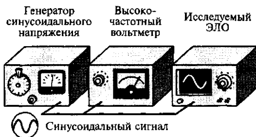
Рис. 4.17. Экспериментальное определение АЧХ канала УЭЛО
