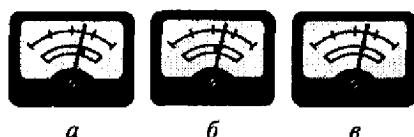
Рис. 1.20. Устранение погрешности параллакса:
