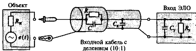
Рис. 4.22. Подключение входного кабеля с делением
