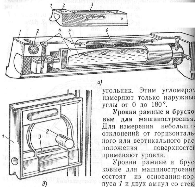
Рис. 6.7. Уровни брусковый (а) и рамный (б)
