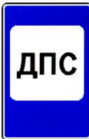
7.12 Пост дорожно- патрульной службы
